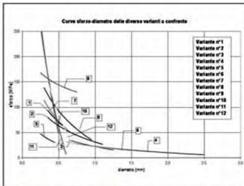
Figura 2. Risultati sperimentali di prove di trazione su alcune specie erbacee (Dipartimento di Ingegneria Agraria dell'Università degli Studi di Milano, 2009).
